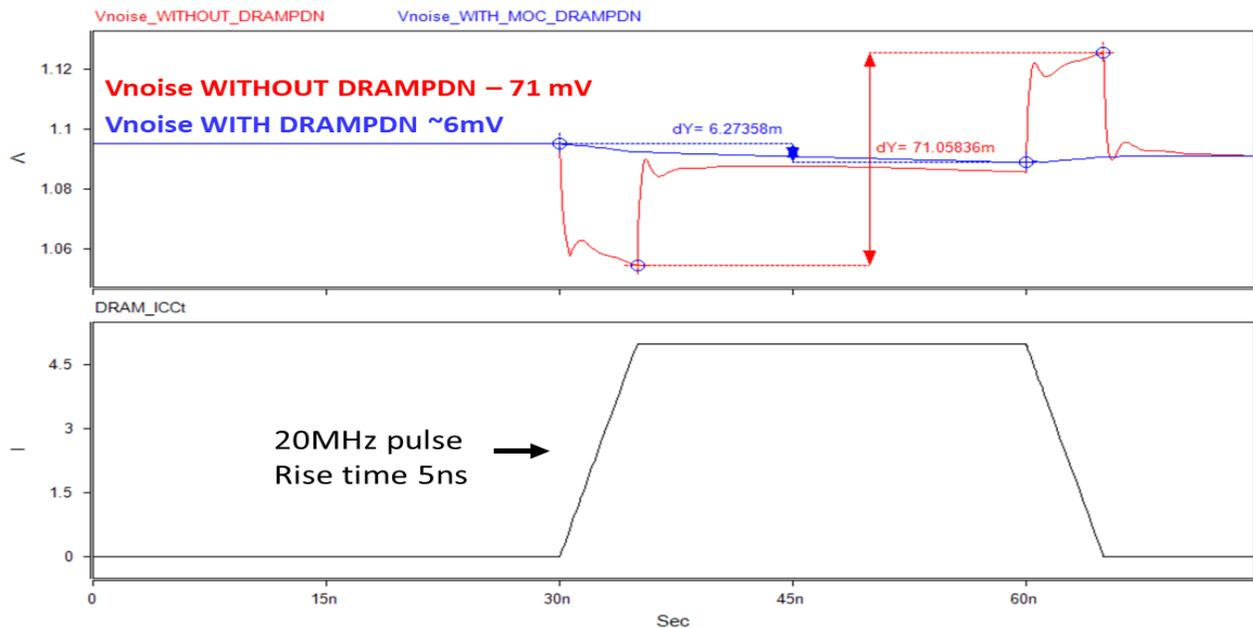
Figure- 9(a): VDD2 Voltage noise waveform
