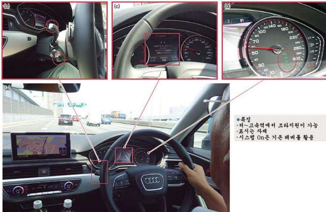
· 차량은 ‘A4’. (a)인스트루먼트 패널. (b)시스템을 On으로 하는 레버. 각 레버의 끝에 있는 버튼을 누른다. (c)핸들에서 손을 떼면 15초 정도에 경고 표시 ‘스티어링 조작을 계속하십시오!’와 함께 소리로 알림(초 수는 도로 환경에 따라 변함). (d)시스템 가동 상태는 미터 아래의 표시로 확인 가능하다. 아이콘은 위에서부터 정체 추종, 선행차 추종, 맨 밑은 차선유지지원 시스템이다.
