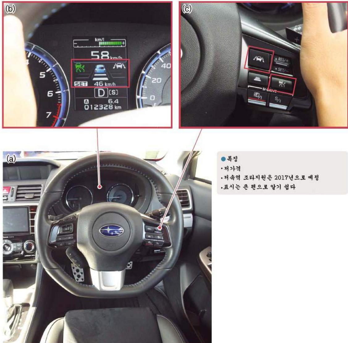
· 차량은 '리보그'. (a)인스트루먼트패널. (b)시스템 가동상태. 왼쪽 아이콘의 선행차 추종 시스템은 On(녹색), 오른쪽 아이콘의 차선유지 지원 시스템은 Off(흰색)로 되어 있다. (c)설정 버튼. 중간단의 오른쪽이 선행차 추종, 상단의 왼쪽이 차선유지 지원 시스템
