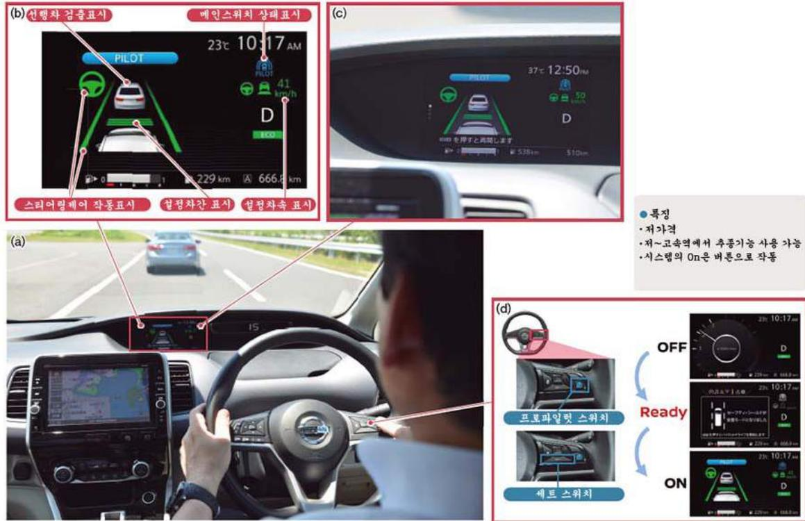
· 차량은 미니밴 ‘세레나’. (a)인스트루먼트 패널. (b)시스템 가동 상태. (c)선행차가 3초 이상 정지한 경우의 표시. 시스템 재개를 위해 버튼 조작을 요청하고 있다. (d)시스템을 켤 때는 버튼만 누르면 된다. 차속 설정에서 두 번째 버튼을 조작한다.
