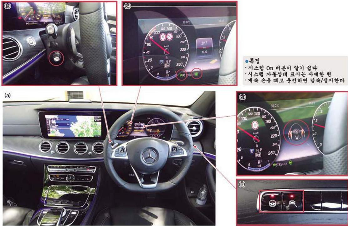
· 차량은 ‘E클래스’. (a)인스트루먼트패널. (b)차속 설정용 레버. (c)시스템 가동 상태는 미터 우측 밑에 표시한다. 왼쪽이 선행차 추종, 오른쪽이 조타지원 시스템. (d)핸들에서 손을 놓고 운전하면 경고 표시가 나온다. (e)시스템을 On으로 하는 버튼
